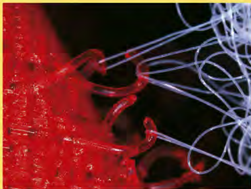
Imagem do velcro feita ao microscópio.
